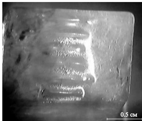
Рис. 7. Поверхность кристаллизации кристалла \text{BaWO}_4 , выращенного методом Степанова с формообразователем, имеющим ширину щелей 1 мм. 22, 23 Видно, как кристалл прорастает в капиллярные щели.
